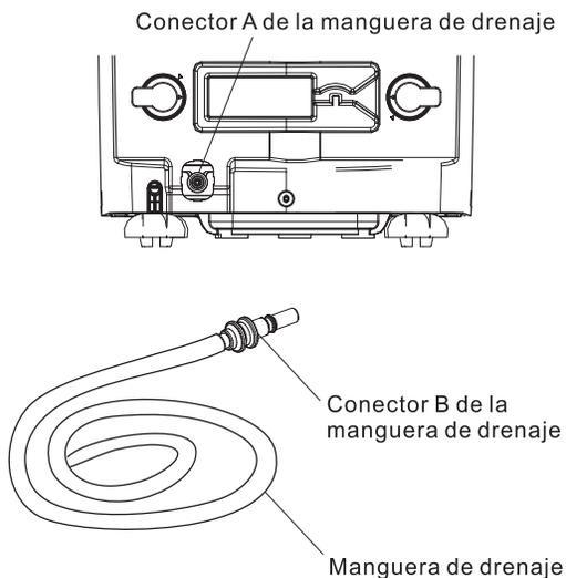
1. Para conectar la manguera de drenaje a la unidad, presione el conector B de la manguera de drenaje en el conector A.
