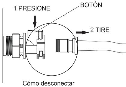
**NOTA:** Si no se utiliza la unidad por cierto período de tiempo, quite el tapón de agua como se muestra en la imagen y drene completamente el deshumificador.
