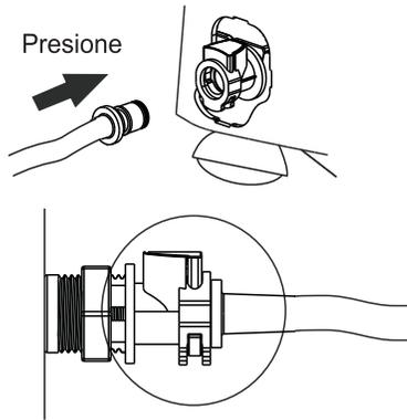
2. Para desconectar la manguera de drenaje, presione el botón de apertura en el conector A y luego retire el conector B.
