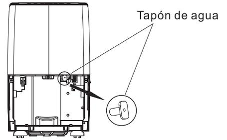
**IMPORTANTE:** Antes de operar el deshumificador, asegúrese de que el tapón de agua esté puesto; de lo contrario, la función de manguera de drenaje y la bomba no funcionarán correctamente.
