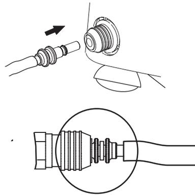
2. Para desconectar la manguera de drenaje, presione el conector A y luego tire del conector B.
