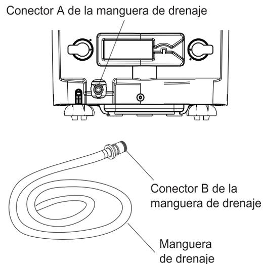
1. Para conectar la manguera de drenaje a la unidad, presione el conector B de la manguera de drenaje al conector A.
